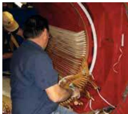
Réparation du bobinage d'un moteur
