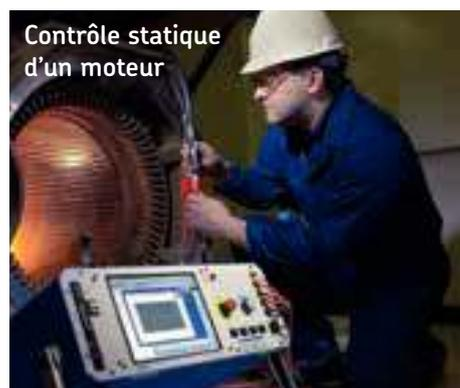
Contrôle statique d'un moteur
