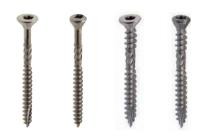
La partie lisse du corps de la vis, égale à 40% de la longueur totale, exerce un effet tirant sur une des deux parties à assembler et permet d'obtenir un serrage correct des pièces.
