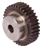
A1-358 Roue cylindrique droite en acier à denture traînée Module 4,0 - Largeur denture 40 mm
