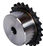
A1-01-105 Pignons à chaîne simple préalésés à denture trempée en acier 10 B1 - Pas 15,875 mm
