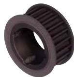
MA A9-H200 Poulie dentée à moyeu amovible pour courroie Pas 12,7 mm (1/2") pour courroie largeur 50,8 mm
