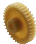
A1-296 Roue cylindrique, résine de polycétone Module 1,25 - Largeur denture 10 mm
