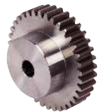
A1-34 Roue cylindrique droite en acier Module 3,0 - Largeur denture 25 mm
