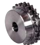
A1-012-16 Pignon à chaîne double norme BS 16 B2 - Pas 25,4 mm
