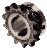
A1-01-128 Pignons alésés clavetés à denture traitée 12 B1 - Pas 19,05 mm
