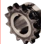
A1-01-088 Pignons alésés clavetés à denture traitée 08 B1 - Pas 12,7 mm
