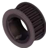
MA A9-14M40 Poulie dentée à moyeu amovible HTD® Pas 14 mm pour courroie largeur 40 mm
