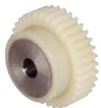
A1-331 Roue cylindrique droite plastique moyeu acier ou inox Module 2,5 - Largeur denture 25 mm
