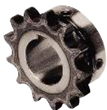
A1-01-168 Pignons alésés clavetés à denture traitée 16 B1 - Pas 25,4 mm
