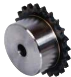
A1-01-165 Pignons à chaîne simple préalésés à denture trempée en acier 16 B1 - Pas 25,4 mm
