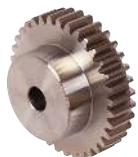
A1-280 Roue cylindrique droite en inox Module 1,0 - Largeur denture 10 mm
