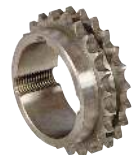
A1-082-12 Pignon à chaîne double, à moyeu amovible 12 B2 - Pas 19,05 mm
