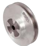
A71-1SPA Poulie à gorge trapézoïdale en alliage léger avec renfort de moyeu en fonte grise, 1 gorge
