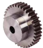
A1-349 Roue cylindrique droite en acier Module 3,0 - Largeur denture 30 mm
