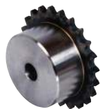
A1-01-125 Pignons à chaîne simple préalésés à denture trempée en acier 12 B1 - Pas 19,05 mm
