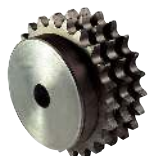
A1-013-08 Pignon à chaîne triple norme BS 08 B3 - Pas 12,7 mm
