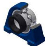
P7-02H Palier à semelle courte en fonte avec serrage par bague excentrique
