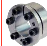
A5-566 Moyeu de serrage court auto-centrant avec ou sans anti-recul, couples élevés
