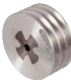
A71-3SPZ Poulie à gorge trapézoïdale en alliage léger avec renfort de moyeu en fonte grise, 3 gorges
