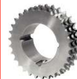
A1-083-16 Pignon à chaîne triple, en acier, à moyeu amovible 16 B3 - Pas 25,4 mm
