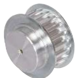
A9-31T10 Poulie dentée monobloc profil T10 Pas 10 mm pour courroie largeur 16 mm
