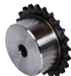
A1-01-085 Pignons à chaîne simple préalésés à denture trempée en acier 08 B1 - Pas 12,7 mm
