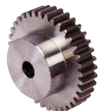
A1-369 Roue cylindrique droite en acier Module 5,0 - Largeur denture 50 mm
