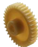
A1-266 Roue cylindrique, résine de polycétone Module 0,5 - Largeur denture 3 mm
