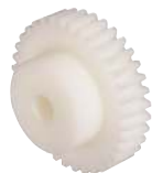
A1-275 Roue cylindrique droite en POM H Module 0,7 - Largeur denture 5 mm
