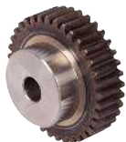
A1-328 Roue cylindrique droite en acier à denture traînée Module 2,0 - Largeur denture 20 mm
