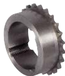
A1-08-06 Pignon à chaîne simple, à moyeu amovible 06 B1 - Pas 9,525 mm
