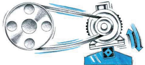
Permet un léger glissement au démarrage lors d'une masse d'inertie élevée. Protège les courroies - roulements - poulies
