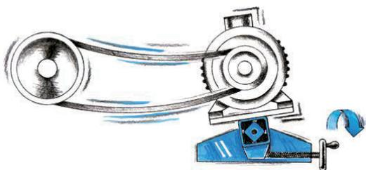
Remplacement simple et rapide des courroies, pas de réglages fastidieux des poulies.
