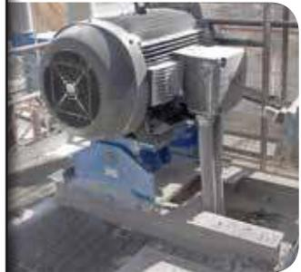
Dotées d'un élément ressort élastique précontraint, les bases moteurs oscillantes ROSTA **compensent automatiquement l'allongement, les à-coups, les oscillations et les tensions excessives sur les courroies.**
