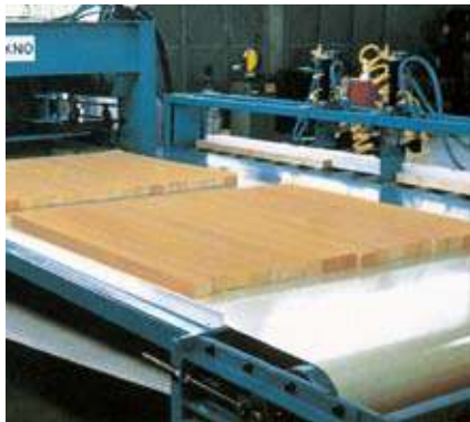
Fabrication de lamellés collés.
