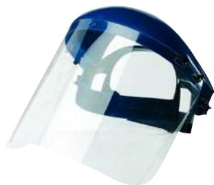
Composé d'une calotte et d'une face en polycarbonate incolore relevable. Le serre-tête se règle aisément, la visière est facile à remplacer. Protège contre les impacts de moyenne énergie et les projections de liquides. Offre une couverture prolongée sur le dessus de la tête. Dimensions: (L x l) 220 x 390 mm. Norme EN 166.
