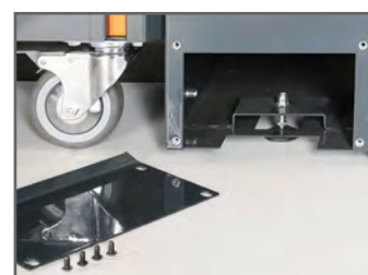
Pieds d'appui réglables permettant de s'adapter aux surfaces irrégulières
