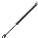
B1-RAG-08S Page 365 Ressort à gaz - Tige diamètre 8 à œillet Force maxi 750 N
