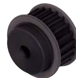
A9-8M20 Poulie dentée monobloc HTD® Pas 8 mm pour courroie largeur 20 mm
