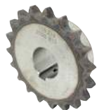
A1-01-108 Pignons alésés clavetés à denture traitée 10 B1 - Pas 15,875 mm
