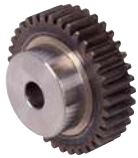
A1-368 Roue cylindrique droite en acier à denture traitée Module 5,0 - Largeur denture 50 mm
