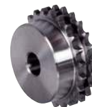
A1-012-06 Pignon à chaîne double norme BS 06 B2 - Pas 9,525 mm
