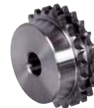
A1-012-08 Pignon à chaîne double norme BS 08 B2 - Pas 12,7 mm
