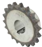
A1-01-128 Pignons alésés clavetés à denture traitée 12 B1 - Pas 19,05 mm
