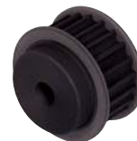
A9-8M50 Poulie dentée monobloc HTD® Pas 8 mm pour courroie largeur 50 mm
