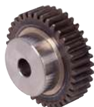
A1-328 Roue cylindrique droite en acier à denture traitée Module 2,0 - Largeur denture 20 mm
