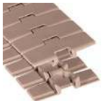
SERIE 879 Flexion latérale, charnière simple à guidage queue d'aronde avec palette supérieure épaisse
