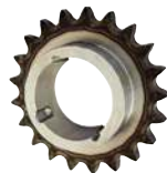
A1-01-168 Pignons à moyeux amovibles en acier à denture traitée 16 B1 - Pas 25,4 mm
