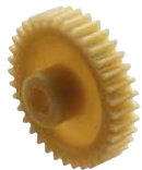
A1-326 Roue cylindrique, résine de polycétone Module 2 - Largeur denture 15-19 mm
