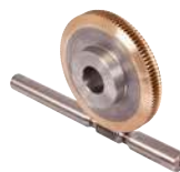
A1-77 Engrenage à vis cylindrique - Montage carter Entraxe 100 mm ±0,03
