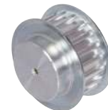
A9-66T10 Poulie dentée monobloc profil T10 Pas 10 mm pour courroie largeur 50 mm
