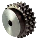
A1-013-12 Pignon à chaîne triple norme BS 12 B3 - Pas 19,05 mm
