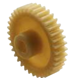
A1-286 Roue cylindrique, résine de polycétone Module 1 - Largeur denture 9 mm
