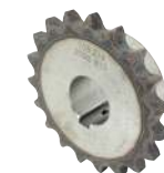
A1-01-068 Pignons alésés clavetés à denture traitée 06 B1 - Pas 9,525 mm
