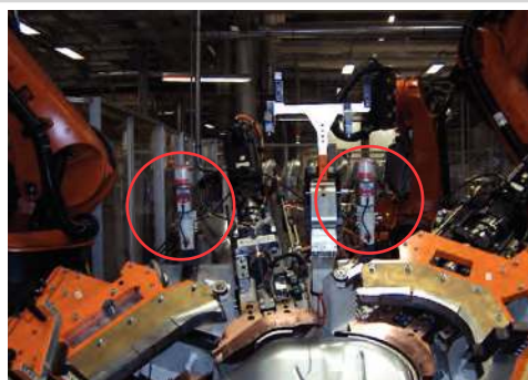
Lubrification des broches et guidages plats
