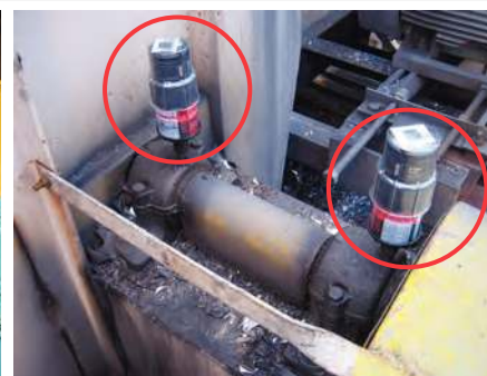
Lubrification d'un assemblage d'arbre de ventilateur
