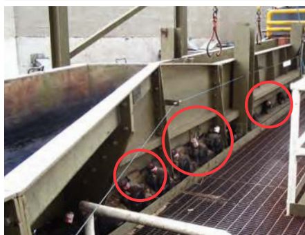
Lubrification des paliers sur les systèmes de triage d'arbres
