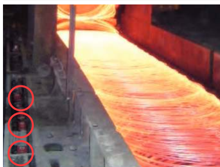
Lubrification de chaînes d'entraînement (convoyeur de fil à vis)
