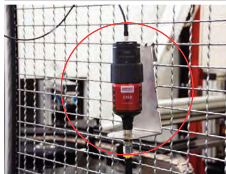
Lubrification automatique d'un guidage à glissement
