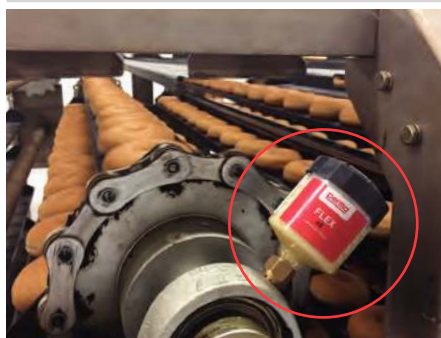
Lubrification du palier fonte sur une course de refroidissement pour pâtisseries
