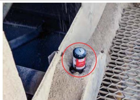
Lubrification du palier fonte sur dessableurs & cribles vibrants
