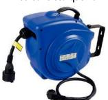
Câble 3x2,5 mm<sup>2</sup> H07RN-F. Flexible de raccordement 1 m. 2500 W déroulé sous 230 V. 800 W enroulé sous 230 V. IP20. Disjoncteur thermique. Conforme norme CE 2014/35/UE. Poids: 7,39 kg.
