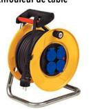
Équipé de 4 prises 2P+T - 16 A - 230 V à volet d'obturation. Disjoncteur thermique. Câble H07RNF. Section: 3G2,5 mm<sup>2</sup>. Indice de protection IP 44. Norme NF EN 61242.
