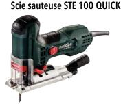
Puissance absorbée nominale: 710 W. Puissance utile: 470 W. Profondeur de coupe dans le bois : 100 mm. Métaux non ferreux : 25 mm. Tôle d'acier: 10 mm. Plage d'inclinaison : de -45° à +45°. Niveaux de la fonction pendulaire: 4. Vitesse en marche à vide : 1000 - 3100 /min. Course de la lame de scie : 22 mm.
