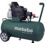
Compresseur à pistons huilés. Raccord rapide universel. Poignée caoutchoutée. Puissance d'aspiration: 200 l/min, de remplissage : 110 l/min. Pression maxi: 8 bars. Réservoir: 50 litres. Niveau sonore (LpA): 97 dB(A). Dimensions: 830 x 445 x 715 mm.
