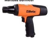
Compatible avec burins à entraînement hexagonal de 10 mm. Pour le cisaillage des boulons, le découpage de la tôle, de la carrosserie, l'élimination des points de soudure, des rivets, des enduits et des carreaux. Echappement de l'air par la poignée. Nombre de coups à la minute : 2 900.
