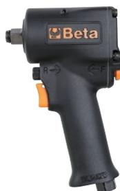
Extrêmement compacte et puissante : 770 Nm. Mécanisme à simple frappe. Trois niveaux de réglage de la puissance de vissage et de dévissage. Échappement de l'air par la poignée. Vitesse à vide : 10 000 tr/min. Couple de serrage maximum : 770 Nm. Pression d'utilisation : 6,2 bars. Consommation d'air moyenne : 122 l/min. Ø intérieur du tuyau d'air : 10 mm. Filetage d'arrivée d'air : 1/4" GAS.
