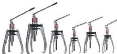
Centrage automatique, facile à convertir en 2 ou 3 bras. Les bras glissent vers l'intérieur ou l'extérieur en même temps. Pompe hydraulique autonome compacte. Peut être utilisé dans n'importe quelle position. Ecartement maxi : 450 mm. Portée : 280 mm maxi. Course de vérin : 85 mm.
