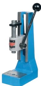
Puissance : 200 kg. Course : 0 à 50 mm. Profondeur de col de cygne : 72 mm. Hauteur libre : 54 à 200 mm. Poids : 8 kg. Aucun entretien ni graissage. Prédiposition pour la fixation sur un établi.
