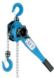
Manuel extra-léger, compact, pour tendre, tirer, lever, positionner. Chaîne de levage traitée anticorrosion. Crochets à rotation libre 360° avec linguet de sécurité. Fermeture automatique du frein dès qu'une charge est appliquée. Sécurité de fin de chaîne. Poignée du levier en caoutchouc noir. Course de levage standard : 3 m. Conforme : 2006/42/CE.
