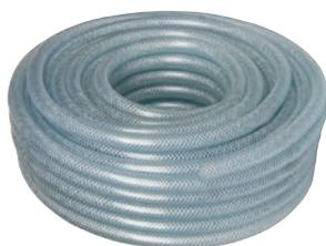
Tuyaux polyvalent adapté à de nombreux usages : alimentation de machine et d'outillage en air comprimé, passage de gaz industriels, passage de produits alimentaires : jus de fruits, vins, alcools forts et lait, transfert de certains produits chimiques : acides et bases, refoulement d'eau (traitement des eaux), vide. PVC souple tressé. Température : -15°C à +60°C. Autres longueurs.
