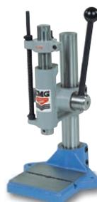
Puissance : 600 kg. Course : 0 à 100 mm. Profondeur de col de cygne : 95 mm. Hauteur libre : 46 à 280 mm. Poids : 25 kg. Aucun entretien ni graissage. Prédiposition pour la fixation sur un établi.
