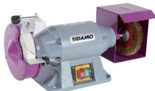
Meule et brosse : 150 x 25 x 32. Grain de meule : AA 60 M. Brosse : Acier laitonné. Vitesse de rotation : 2 800 tr/min. Puissance : 0,52 kW. Dimensions L x p x H : 525 x 260 x 220 mm. Meulage à sec et polissage de métaux ferreux.
