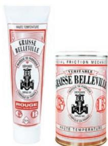
Spéciale friction mécanique. Résiste aux pressions extrêmes. Est insoluble dans l'eau, même bouillante. Offre une excellente tenue à l'eau de mer. Présente une adhérence exceptionnelle. Grade NLGI : 2,5. Températures : -30°C à +220°C (+400°C en pointe).
