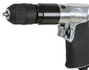
Vitesse à vide : 1800 tr/min. Capacité mandrin : 1 à 10 mm. Puissance : 0,23 kW. Filetage de la broche : 3/8" - 24UNF. Filetage d'arrivée d'air : 1/4" GAS. Pression d'utilisation : 6,2 bars. Ø intérieur du tuyau d'air : 10 mm. Consommation d'air moyenne : 160 l/min. Poids : 1,2 kg.
