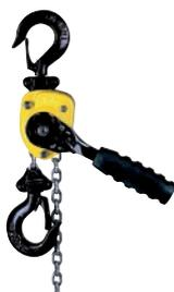
Le plus petit et le plus léger palan Yale destiné aux professionnels. Idéal pour les travaux de redressage, en métallerie, artisanat, SAV et pour les efforts importants dans des endroits exigus. Système de roue libre en série permettant une approche rapide du crochet de la charge. Levier avec poignée caoutchouc ergonomique. Pièces zinguées traitées anticorrosion. Course de levage standard : 1,5 m.
