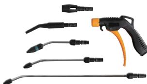
3 buses en acier 100/160/320 mm avec embout de protection en caoutchouc anti-rayures. 1 buse "Turbo" en nylon renforcé avec fibres de verre et embout de sécurité. 1 buse orientable 100 mm nylon renforcé avec fibres de verre. Embout cuivre fileté : 1/4" GAS. Pression d'utilisation : 10 bars.
