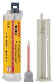
Remplissage des jeux, bi-composant, faible efflorescence : jusqu'à 5 mm. Multi-matériaux, haute résistance. Polymérisation rapide. Temps de prise : 90 - 150 s. Plage de températures de service : -40°C à +80°C. Fourniture : Livré avec 7 buses.
