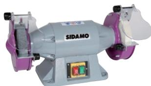
Meulage à sec de métaux ferreux. Carters en acier embouti équipés d'une buse de captage des poussières. Écran de protection en polycarbonate. Corps en fonte d'acier. Meule : 150 x 25 x 32. Grain de meule : A 36 R / AA 60 M. Vitesse de rotation : 2 800 tr/min. Puissance : 0,52 kW. Dimensions L x p x H : 465 x 210 x 260 mm.
