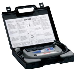
Pour réaliser des joints toriques de différentes tailles. Couleur : transparent et incolore. Temps de prise : 2-10 sec. Températures de service : -40 à + 80°C. Jeu maximum : < 0,15 mm.
