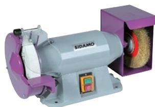
Meule et brosse : 200 x 30 x 32 et 200 x 25 x 32.. Grain de meule : AA 60 M. Brosse : Acier laitonné. Vitesse de rotation : 2 800 tr/min. Puissance : 0,9 kW. Dimensions L x p x H : 570 x 265 x 330 mm. Meulage à sec et polissage de métaux ferreux.
