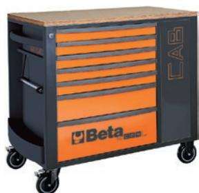
7 tiroirs (588x367 mm), montés sur glissières à billes de précision. Quatre roues de Ø 125 mm : 2 fixes et 2 pivotantes (dont deux avec frein). Petite armoire latérale avec porte munie de serrure et rayon interne réglable en hauteur. Capacité de charge statique : 1 100 kg. Plan de travail en bois contre-plaqué stratifié avec trous pour l'installation d'un étau (en option). Double porte-flacons arrière.
