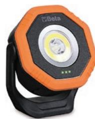
Avant : LED COB, 3 intensités lumineuses : 160 - 400 - 800 Lumens, en tête (spot) : LED SMD, 250 Lumens. Batterie rechargeable Li-ion 3,7V - 2600 mAh. 2 modes de charge : base sans fil 1839BRW ou chargeur USB-C. Autonomie : avant : 3-9h. Tête (spot) : 4,5h. Base orientable à 210°. En option : Base de recharge sans fil 189BRW.
