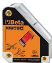
Idéal pour positionner vos pièces avant de souder. 27 kg de force magnétique. Sans pile, effet marche/arrêt obtenu avec l'inclinaison des aimants internes. L'interrupteur sur arrêt permet de démagnétiser l'aimant et de se débarrasser de limailles de fer.
