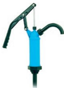
Transfert de lave glace, antigel, eau, gasoil, fuel et huile. Tube plongeur télescopique et d'un bec d'écoulement. Adaptable pour fûts et tonnelets. Débit libre : 0,3 l/coup. Raccord de connexion : 2". Matière : Polypropylène. Joints : Viton.
