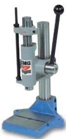
Puissance : 400 kg. Course : 0 à 80 mm. Profondeur de col de cygne : 80 mm. Hauteur libre : 35 à 270 mm. Poids : 17 kg. Aucun entretien ni graissage. Prédiposition pour la fixation sur un établi.
