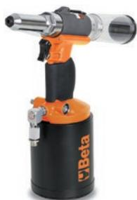
Riveteuse professionnelle pour rivets en acier, acier inox, aluminium et cuivre, de 4,8 - 5,6 - 6,4 - 7,8 mm. Puissance de traction : 16900 N. Longueur de la course : 22,5 mm. Pression d'utilisation : 6,2 bars. Consommation d'air : 113 l/min. Ø intérieur du tuyau d'air : 10 mm. Capacité maximum : Ø acier inoxydable 7,8 mm.
