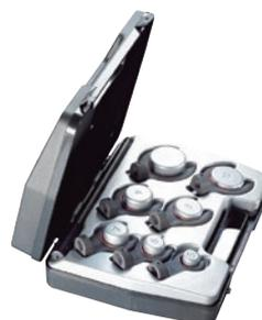
Clé de serrage d'écrou KM. Chaque clé est marquée de l'angle de serrage correct pour le montage des roulements à rotule sur billes. Quatre points de préhension sur chaque clé. Limite les risques d'endommager du roulement avec un serrage excessif.
