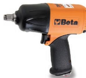
Commande d'inversion à levier. Trois niveaux de réglage de la puissance de vissage. Échappement de l'air par la poignée. Vitesse à vide : 7 500 tr/min. Masse battante : Double frappe. Couple de serrage maximum : 1750 Nm. Pression d'utilisation : 6,2 bars. Consommation d'air moyenne : 290 l/min. Ø intérieur du tuyau d'air : 9,5 mm.
