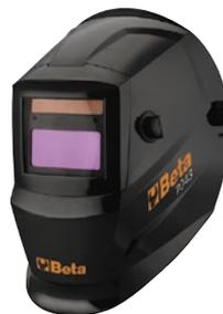
Champ de vision 92x43 mm. Tonalité d'obscurcissement DIN 9-13 avec réglage externe. Protection UV/IR. Temps d'obscurcissement 1/1000 s. Temps d'éclaircissement 0.1-1.0 s. Retard de l'obscurcissement réglable. Mise en marche et arrêt automatiques. Fonction de meulage. Forme optimisée pour faciliter la respiration lorsque la visière est abaissée.
