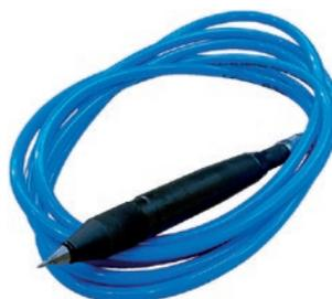
Graveur complet muni d'une pointe moyenne, 500 à 600 percussions par seconde à 6 bars. Réglage de la vitesse de percussion. Pointe carbure très dure. Tuyau de raccordement flexible, longueur 2,5 m. Raccordement 1/4 mâle. Grave toutes surfaces, même le verre et l'inox.
