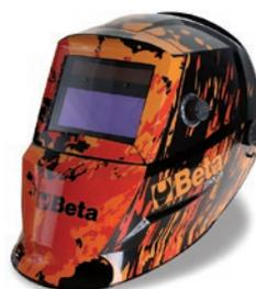
Masque LCD à obscurcissement automatique pour soudage à l'électrode ; MIG/MAG ; TIG et plasma. Alimentation par cellules solaires et batteries au lithium pour une durée exceptionnelle du filtre LCD. Champ de vision : 98x43 mm. Tonalité d'obscurcissement DIN 9-13 avec réglage externe. Protection UV/IR. Temps d'obscurcissement : 1/25000 s. Temps d'éclaircissement : 0,25-1s.
