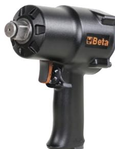
Extrêmement compacte et puissante. Mécanisme à double frappe. Trois niveaux de réglage de la puissance de vissage. Échappement de l'air par la poignée. Vitesse à vide : 5 100 tr/min. Couple de serrage maximum : 1600 Nm. Pression d'utilisation : 6,2 bars. Consommation d'air moyenne : 175 l/min.
