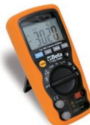
Valeur efficace vraie RMS. Protection jusqu'à 1 000 V. IP67. Entrées protégées. Sélection automatique d'échelle. Sonde de température de type K (fournie). Pointes à double isolation 1000V, longueur 1 m. CAT IV 600V/ CAT III 1000V. Fourni avec étui souple.
