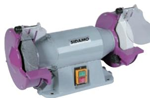
Meule : 200 x 30 x 32. Grain de meule : A 36 R / AA 60 M. Vitesse de rotation : 2 800 tr/min. Puissance : 0,9 kW. Dimensions L x p x H : 515 x 265 x 330 mm. Meulage à sec de métaux ferreux. Corps en fonte d'acier. Écran de protection en polycarbonate.
