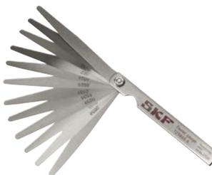
Les jauges d'épaisseur SKF 729865 A sont conçus pour mesurer les jeux. Ils peuvent être utilisés pour mesurer le jeu interne lors de l'ajustement des roulements à rotule sur rouleaux. Le jeu 729865 A comprend 13 lames d'une longueur de 100 mm fourni avec un étui protecteur en plastique.
