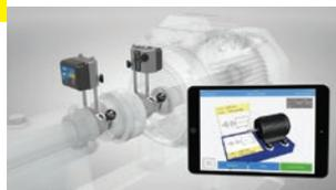
Les mesures peuvent être démarrées à n'importe quel angle et requièrent une rotation minimale totale de seulement 40 degrés.
