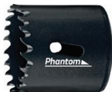
Denture variable et angle de coupe positif, profondeur de coupe 38 mm et 34 mm à partir de 70 mm. 8 % de cobalt.
