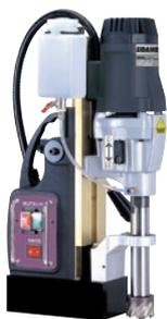
Perçage et carottage sous lubrification de l'acier. Base à forte attraction magnétique de 30 000 N. Écran de protection. Adaptateur pour mandrin de foret. Mandrin à clé 16 mm pour foret. Réservoir à liquide de coupe intégré. Lubrification par le centre de l'outil. Livrée dans mallette de transport avec : Chaîne de sécurité. Clefs de service 2,5 / 4 / 8 mm. Fraise : 12 à 50 x 75. Foret : 16 x 110. Ø d'usinage maxi : 50 (fraise) - 16 (foret).
