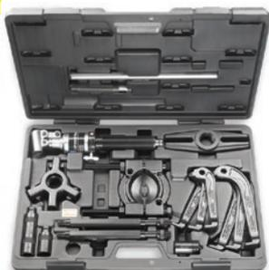
Extracteur hydraulique qui combine un extracteur à griffes et un décolleur de roulements. Le kit comprend deux jeux de bras de différentes longueurs en configuration à 2 ou 3 bras et un décolleur d'une portée maximale de 250 mm. La broche hydraulique avec soupape de sécurité assure le démontage sûr et sans effort. L'extracteur peut également servir à retirer les roulements étanches des paliers borgnes, une fois le joint retiré.
