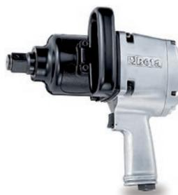
Vitesse à vide : 3500 tr/min. Couple de serrage maximum : 2445 Nm. Mécanisme à double frappe. Extrêmement légère et compacte. Poignée auxiliaire. Commande d'inversion à levier. Trois niveaux de réglage de la puissance de vissage et de dévissage. Échappement de l'air par la poignée. Capacité vis/écrou : classe 8,8 de M36 à 55 mm.
