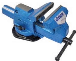
Étau parallèle d'établi en acier. Mors striés interchangeables en acier au chrome-molybdène, cémentés, trempés (+ 55 HRC). Serre-tube incorporé. Tête de coulisse forgée.
