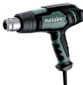
Buse à jet large : 50 mm. Buse de réduction : 20 mm. Quantité d'air : 150 / 300 / 500 l/min. Température de l'air : 80 à 600°C. Puissance absorbée nominale : 2 000 W. Câble : 2,2 m. Coffret en plastique.
