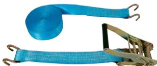
Sangle d'arrimage 2 parties 100% polyester, tendeur à cliquet à double fermeture de sécurité. Crochets 2 doigts écartés. Norme : EN 12195-2. TMU : Tension Maximale d'Utilisation.
