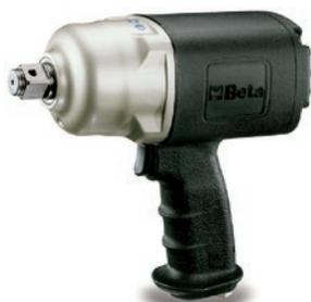
Commande d'inversion à levier. Trois niveaux de réglage de la puissance de vissage. Échappement de l'air par la poignée. Vitesse à vide : 4 500 tr/min. Couple de serrage maximum : 1800 Nm. Pression d'utilisation : 6,2 bars. Consommation d'air moyenne : 215 l/min. Ø intérieur du tuyau d'air : 10 mm.
