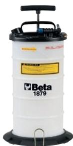
Pour huile moteur, huile boîte de vitesses, liquide de freins, liquide de refroidissement, eau etc. Utilisable avec pompe manuelle ou avec air comprimé. Pression de service : 3-12 bars. Température des liquides : +1°C à 95 °C. Avec 4 raccords en nylon.
