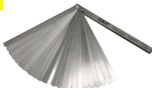
Les jauges d'épaisseur SKF 729865B sont conçus pour mesurer les jeux. Ils peuvent être utilisés pour mesurer le jeu interne lors de l'ajustement des roulements à rotule sur rouleaux. Le jeu 729865B comprend 29 lames d'une longueur de 200 mm avec une armature protectrice en acier.
