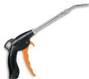
Tube télescopique en acier orientable : 165 mm à 300 mm. Embout en aluminium, filetage : 1/4" GAS femelle. Pression d'utilisation : 6 à 8 bars. Pression d'utilisation maximum : 15 bars. Consommation d'air moyenne : 144 l/min. Température d'utilisation : -20°C à 70°C.
