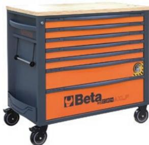
7 tiroirs entièrement amovibles (882x367 mm). Plan de travail en bois contre-plaqué stratifié. Poignée des tiroirs avec porte-étiquette intégré. Fonds des tiroirs avec tapis en néoprène. 2 roues fixes et 2 pivotantes (dont une équipée d'un frein). Serrure de sécurité centralisée frontale. Porte-flacons latéral intégré et modulable sur les deux côtés. Support rouleau de papier intégré.
