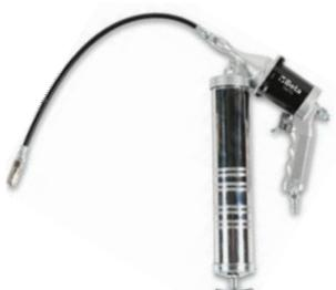
Tête moulée sous pression en aluminium. Manche ergonomique. Vanne en cuivre. Filetage d'arrivée d'air : 1/4" GAZ. Pression d'utilisation : 4 à 10 bars. Poids : 1,9 kg.
