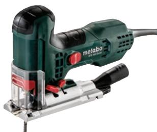
Puissance absorbée nominale : 710 W. Puissance utile : 470 W. Profondeur de coupe dans le bois : 100 mm. Métaux non ferreux : 25 mm. Tôle d'acier : 10 mm. Plage d'inclinaison : de -45° à +45°. Niveaux de la fonction pendulaire : 4. Vitesse en marche à vide : 1000 - 3100 /min. Course de la lame de scie : 22 mm. Poids sans câble : 2 kg. Câble : 4 m.
