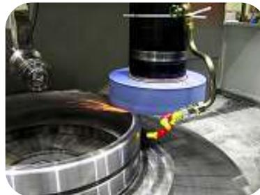
17. Polissage des pistes (dans la limite d'un enlèvement de matière de 13 µm par surface)
