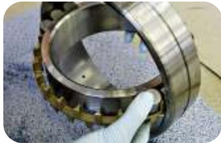
14. Rénovation de la cage ou remplacement par une cage identique
