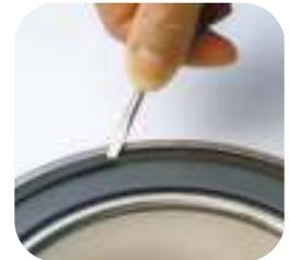
16. Rectification ou polissage et/ou traitement des surfaces de montage selon les besoins afin de rétablir les dimensions nominales d'origine de la surface extérieure et de l'alésage du roulement
