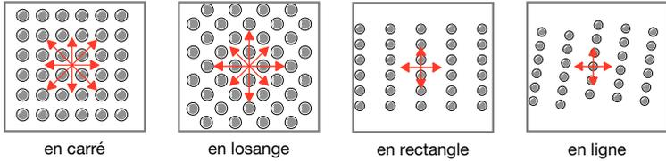
Les flèches rouges indiquent le mouvement idéal de déplacement de la charge.
